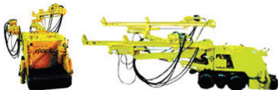
Рис. 41. Бурова установка УБШ-207
