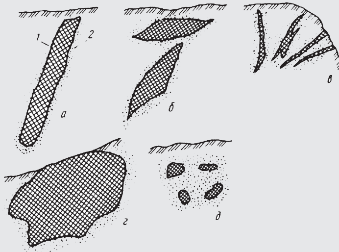
Рис. 2. Форми залягання рудних родовищ: а – пластоподібна, б – лінза, в – жила, г – шток, д – гнізда
