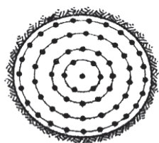
Рис. 69. Схема розташування шпурів при проходженні ствола
