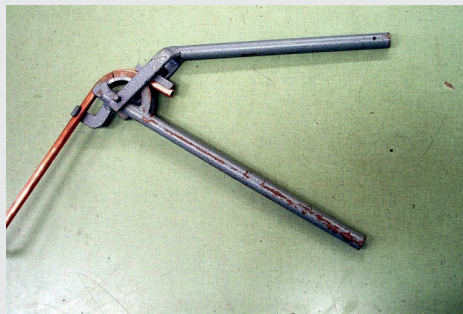
Рис. 12. Вигинання труби з використанням ручного трубовигинача
