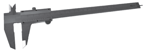
Рис. 14. Штангенциркуль з точністю відліку 0,05 і 0,02 мм
