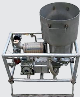
Рис. 48. Зарядник переносний для емульсійної ВР типу ЗЕП-15-01
