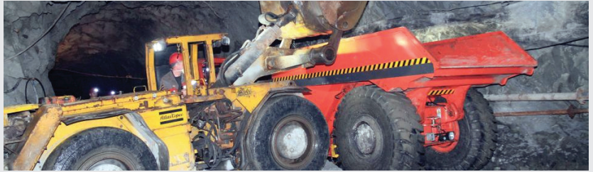
Рис. 57. Прибирання і транспортування підірваної маси у горизонтальних виробках
